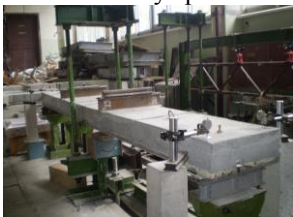
Рисунок 2. Дослідна установка для випробування балок: а) вигляд; б) розрахункова схема
