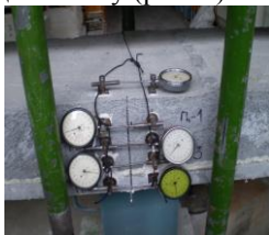
Рисунок 3. Вигляд вимірювання абсолютних деформацій пінобетону та важкого бетону по висоті поперечного перерізу плити по середині прольоту
