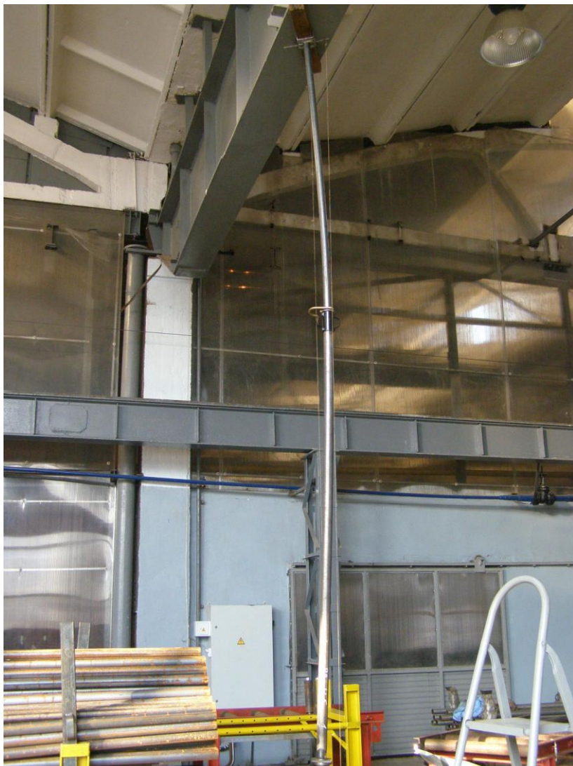
Рис. 5. Поведение стойки под нагрузкой. Прогобы в предкритическом ее состоянии
