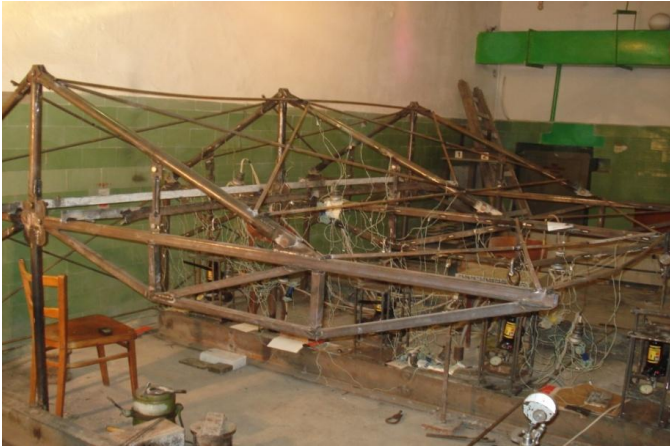
Рис. 4. Загальний вигляд моделі накриття трибун
