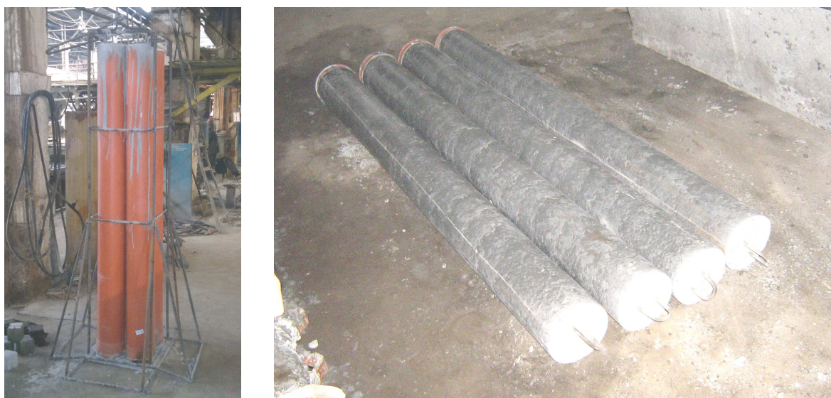
Рис. 2. Бетонирование и образцы железобетонных колонн круглого сечения после изготовления и распалубки.
