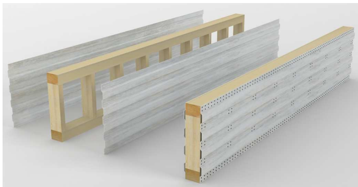
Рисунок 1. Общий вид деревометаллической балки со стенками из стальных профилированных листов с продольной ориентацией гофров.
