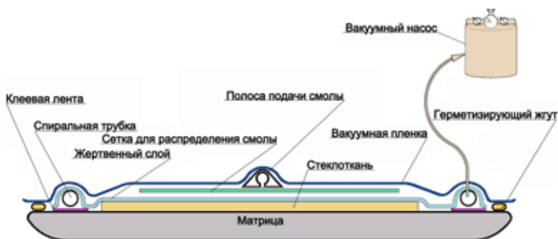
Рис.3. Схема изготовления деревокомпозитной балочной конструкции по методу вакуумной инфузии
