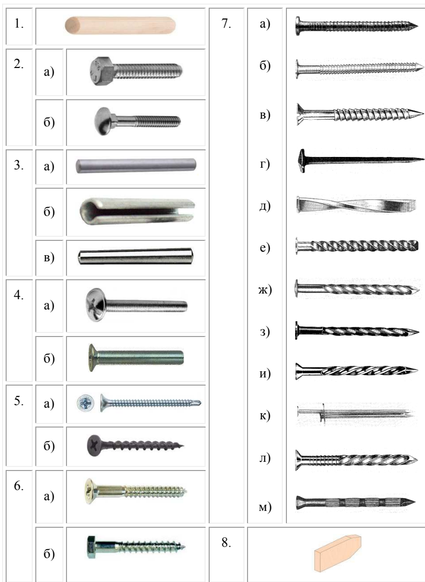
Рисунок 1. Основные типы механических связей нагельного типа в соединениях деревянных конструкций: 1 - деревянный нагель, 2 - болты, 3 - штифты, 4 - винты, 5 - саморезы, 6 - шурупы, 7 - гвозди, 8 - пластинчатый нагель В.С. Деревягина.
