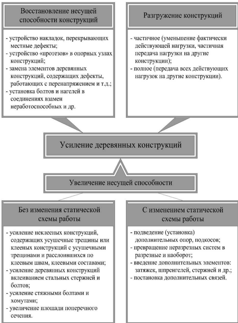
Рисунок 1. Способы усиления деревянных конструкций
