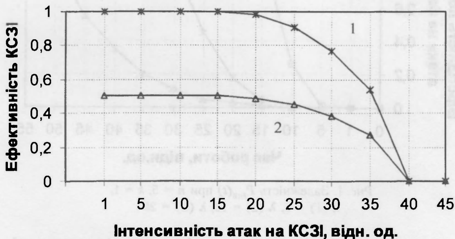
Рис. 3. Залежність \mathcal{E}(\lambda) для КСЗІ при t = 50 , коефіцієнт живучості дорівнює 1 (для графіка 1), 0.5 (для графіка 2)
