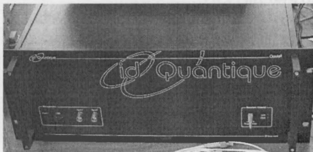
Рис. 4. Швейцарська квантова криптосистема Clavis 2
