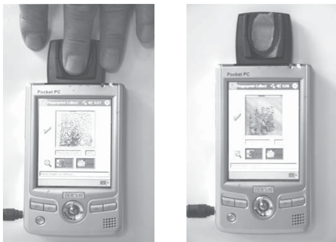
Рис. 6. Введення відбитків муляжів з ємнісного сканера Pocket PC
