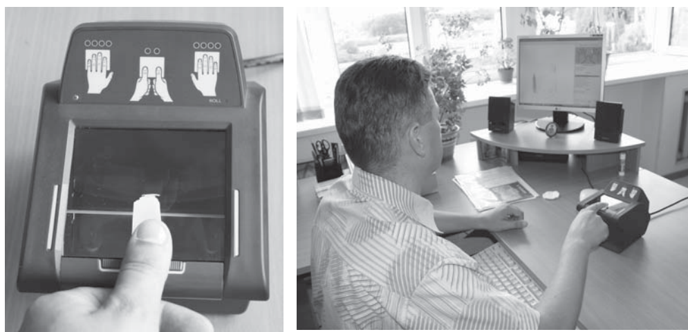
Рис. 4. Введення відбитків муляжів з оптичного долонного сканера DactyScan84
