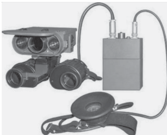
Рис. 6 Денний прилад спостереження й виявлення оптичних систем “Луч-1М”
