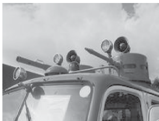
Мал. 3. Вигляд башт з лафетними стволами водомета на шасі Magirus
