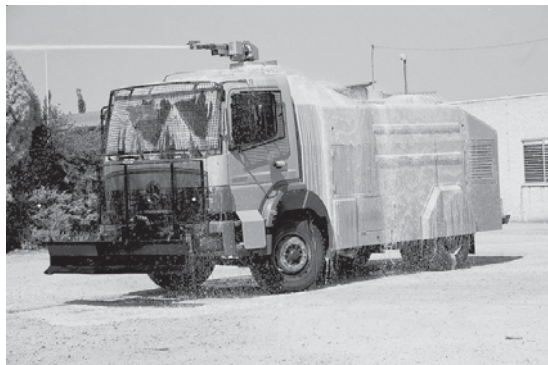
Мал. 9. Водомет ізраїльської фірми Beit Alfa Technologies, на базі Mercedes Axor з включеним верхнім стволом та системою пожежегасіння
