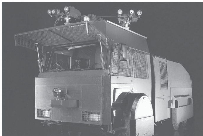
Мал. 4. Водомет Rosenbauer RWD 10000 на шасі Mercedes 1988 року виготовлення
