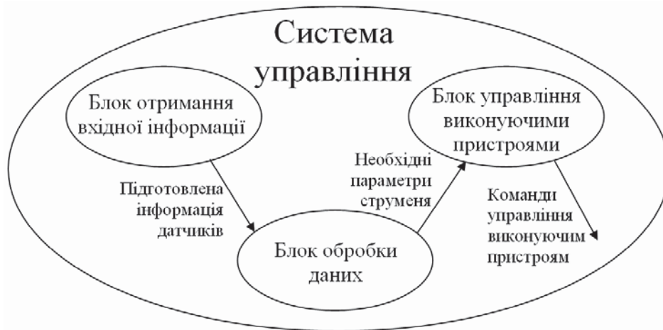
Рис. 2. Структура системи управління заспокоювачем хитавиці
