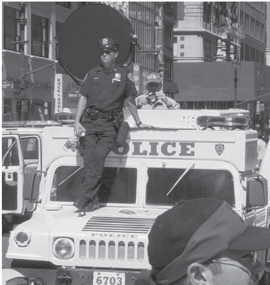
Рис. 1. Пристрій LRAD Sound Cannon, встановлений на джипі Hummer
