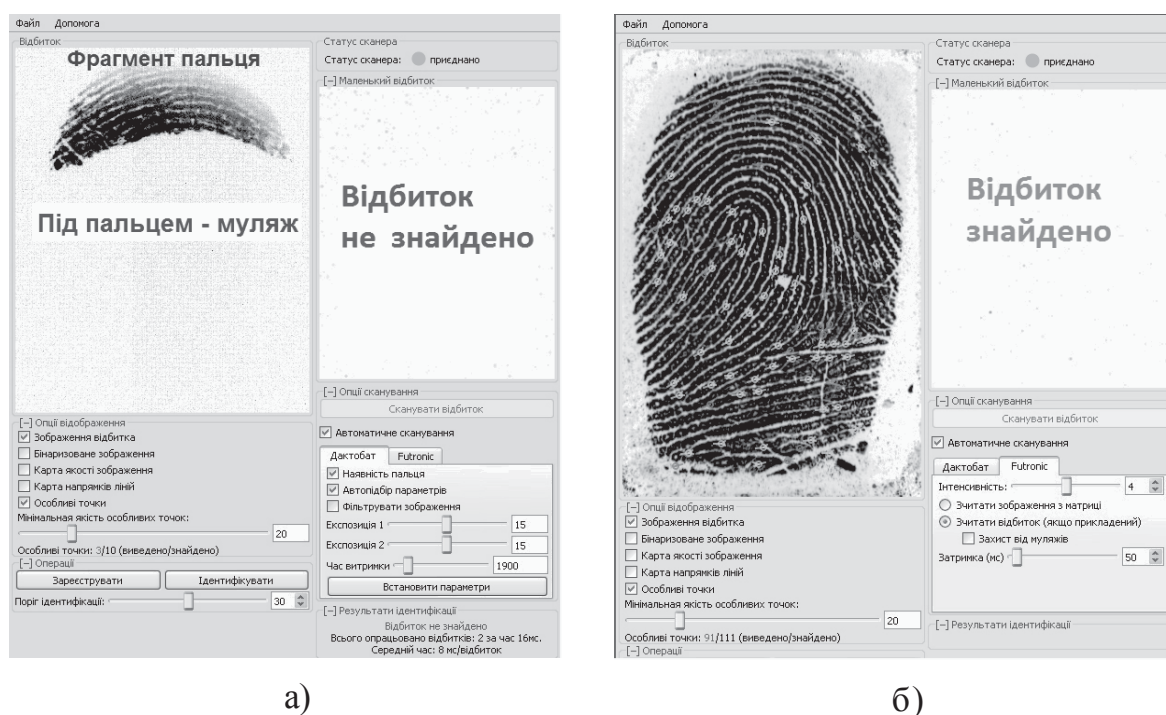
Рис. 9. Відбитки, введені в комп'ютер із електрооптичного сканера "ДактоБАТ": а) відбиток муляжа, б) – відбиток живого пальця
