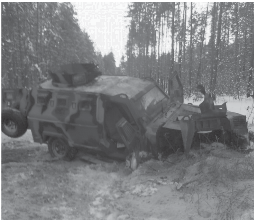
Автомобіль Cougar-APC під час евакуації пораненого в зоні проведення АТО підірвався на міні, проте броня врятувала життя прикордонникам і пораненому військовослужбовцю, які отримали незначні поранення
