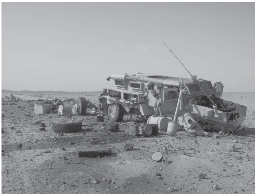
Мал. 11 Бронеавтомобіль Cougar після підриву на потужному вибуховому пристрої. Весь екіпаж автомобіля вижив
