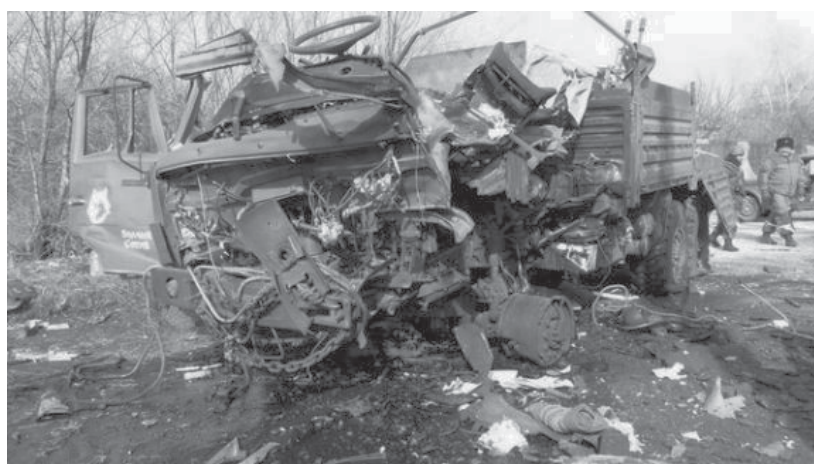
Мал. 4. Характери ураження автомобіля “Камаз” при підриві на міні переднім колесом
