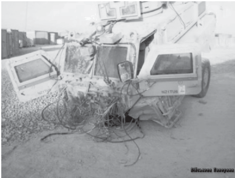
Мал. 7. Відрив коліс, силової установки та зовнішнього обладнання від десантного відділення при підриві автомобіля на міні
