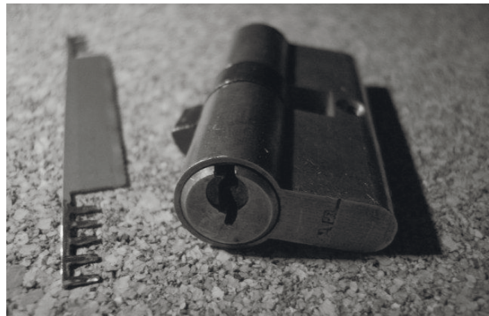
Рис. 18. Пристосування для одночасного опускання штифтових пар (а – патент на метод; б – сучасний інструмент та деблокований ним циліндр)
