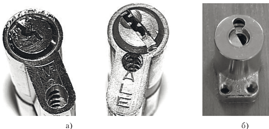
Рис. 12. Позиція свердління корпусу механізму секретності замка (а – для штифтового однорядного з вертикальним та горизонтальним розташуванням замкової шпарини; б – для дискового фінського типу)
