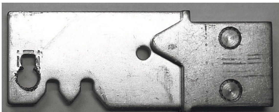
в) Рис. 23. Видалення стійки ригельної планки (а – місце свердління; б – стійка, захищена від висвердлювання; в – ригельна планка із висверделеною стійкою)
