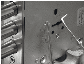
Рис. 26. Інструменти для маніпуляційного деблокування сугальдного замка (а – окремий натяг та щуп; б – комбінований інструмент)
