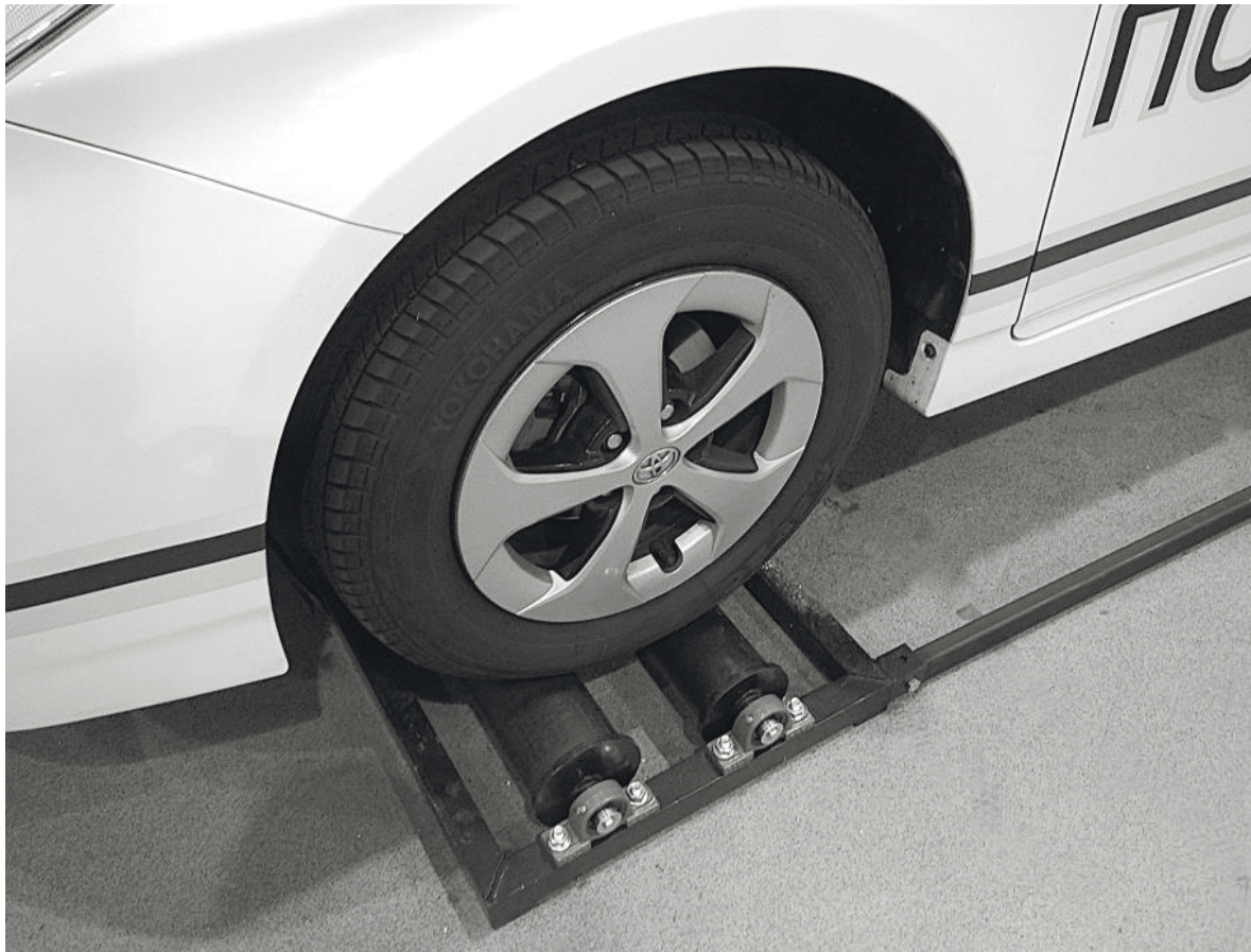
Рис. 2. Ведучі колеса автомобіля на ексцентричних валиках
