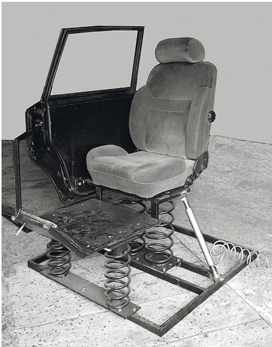
Рис. 3. Дверцята з кріслом, розміщені на підпружиненій платформі з пневматичним приводом
