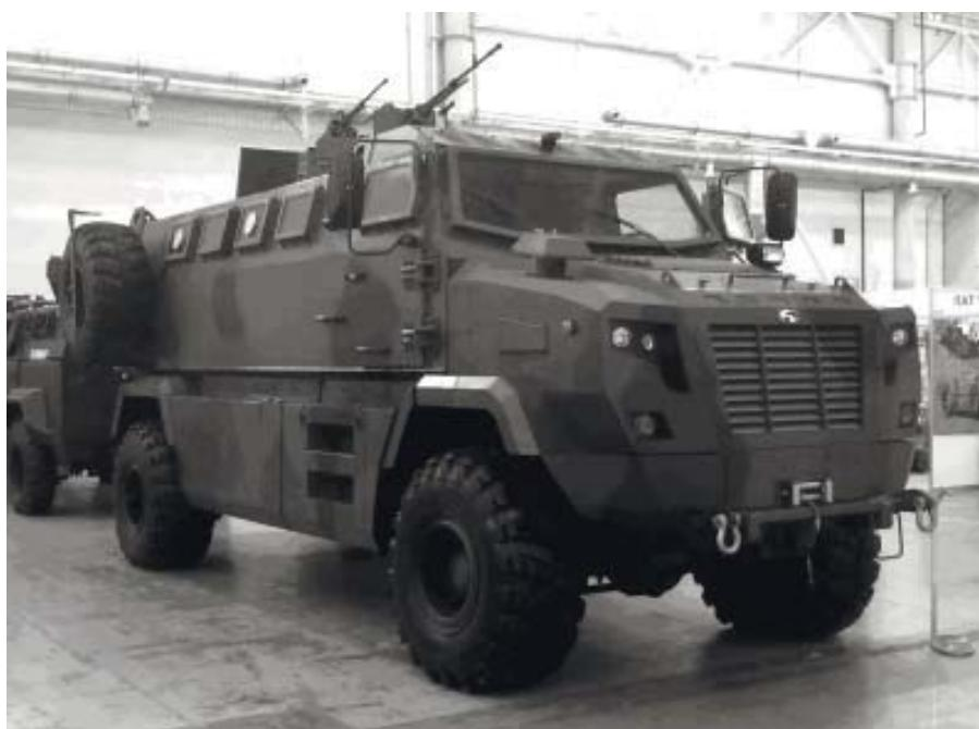
Броньований повнопривідний автомобіль призначений для оперативної доставки особового складу військових підрозділів по дорогах з різноманітним покриттям та бездоріжжю в зону бойових дій та вогневої підтримки.
