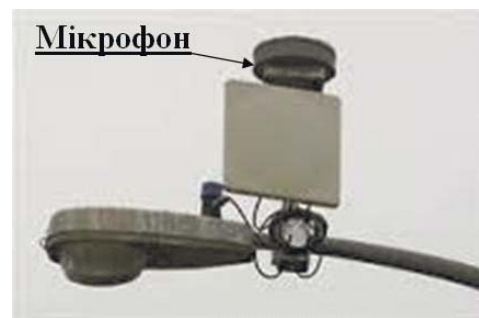
Рис. 9. Елемент акустичної системи ShotSpotter (США)
