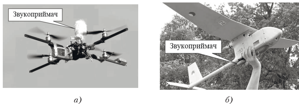
Рис. 3. Варіанти встановлення AVS на БПЛА: а) встановлення на коптер; б) встановлення на RQ-11B Raven
