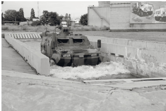
Рис. 7. Подолання перешкоди “Басейн” глибиною 0,75 м без підготовки броневаномобілем “Тритон-0104”
