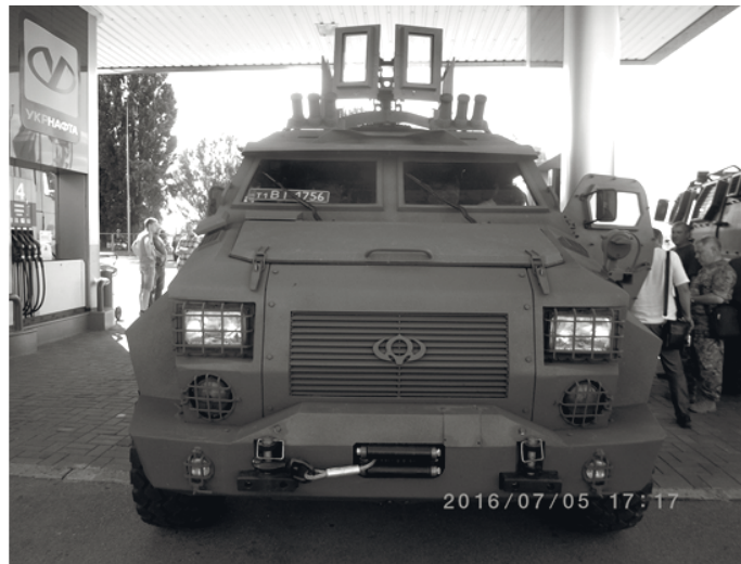
Рис. 3. Замірювання витрат палива бронев автомобіля “Барс-8” під час визначальних відомчих випробувань
