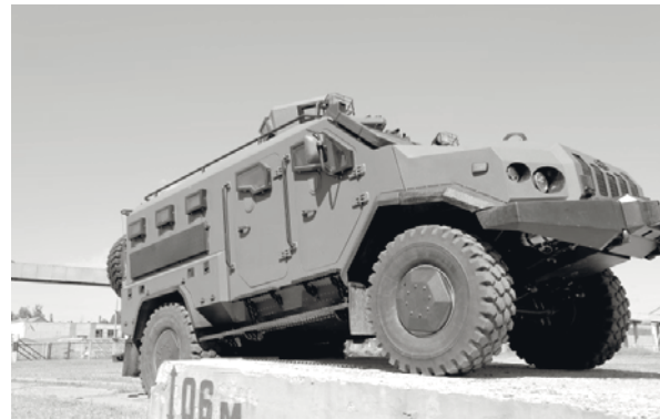
Рис. 8. Подолання перешкоди “Вертикальна стінка” броневаномобілем “ВАРТА”
