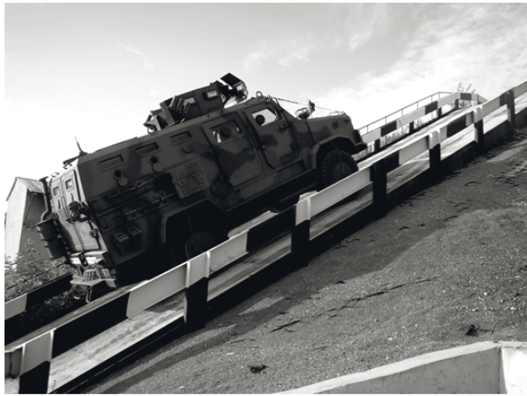
Рис. 5. Подолання перешкоди “Пагорб висотою 10 м” з ухилом 60 % броневаномобілем “Козак-2”
