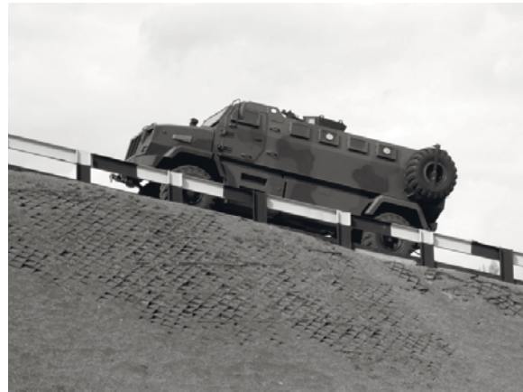
Рис. 6. Подолання перешкоди “Пагорб висотою 10 м” з ухилом 20 % броневаномобілем “КрАЗ–Shrek”
