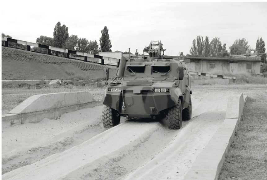
Рис. 9. Подолання перешкоди “Піщана ділянка” бронеавтомобілем “Тритон -0104”
