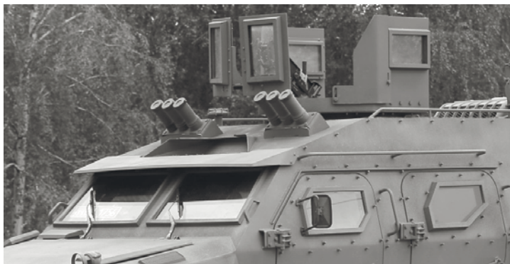
Рис. 3. Система пуску димових гранат бронеавтомобіля “Барс-8”
