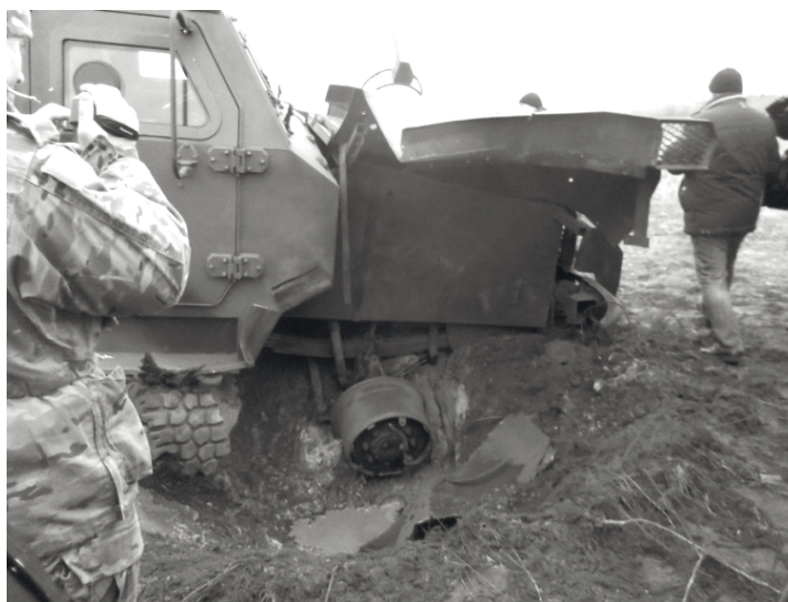
Рис. 6. Випробування бронев автомобіля “Козак-001” підривом під переднім колесом
