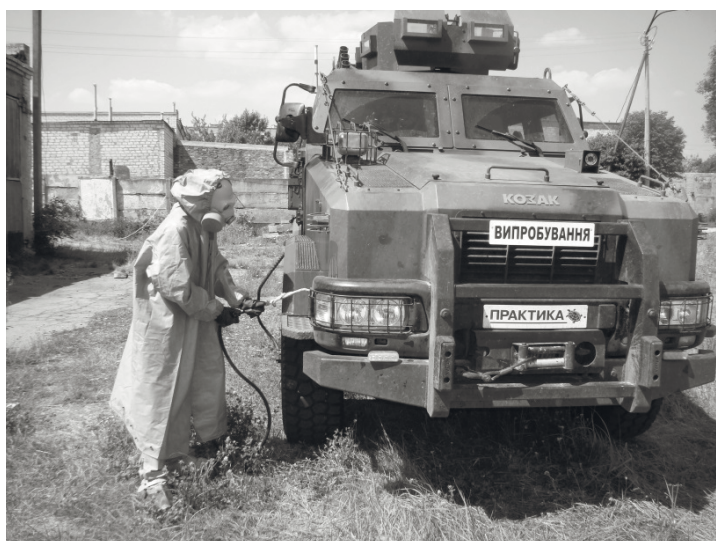
Рис. 1. Проведення перевірки бронев автомобіля “Козак-2” на стійкість до впливу кліматичних факторів і спеціальних рідин
