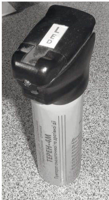
Рис. 8. Експериментальний зразок аерозольного балона зі світлодіодними ліхтарем
