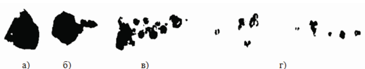
Рисунок 1 - Сталь 08Ю. Изменение формы пластичного сульфида при деформации стали 08Ю со степенью деформации \varepsilon : а) \varepsilon = 10\% ; б) \varepsilon = 20\% ; в) \varepsilon = 35\% ; г) \varepsilon = 60\%
