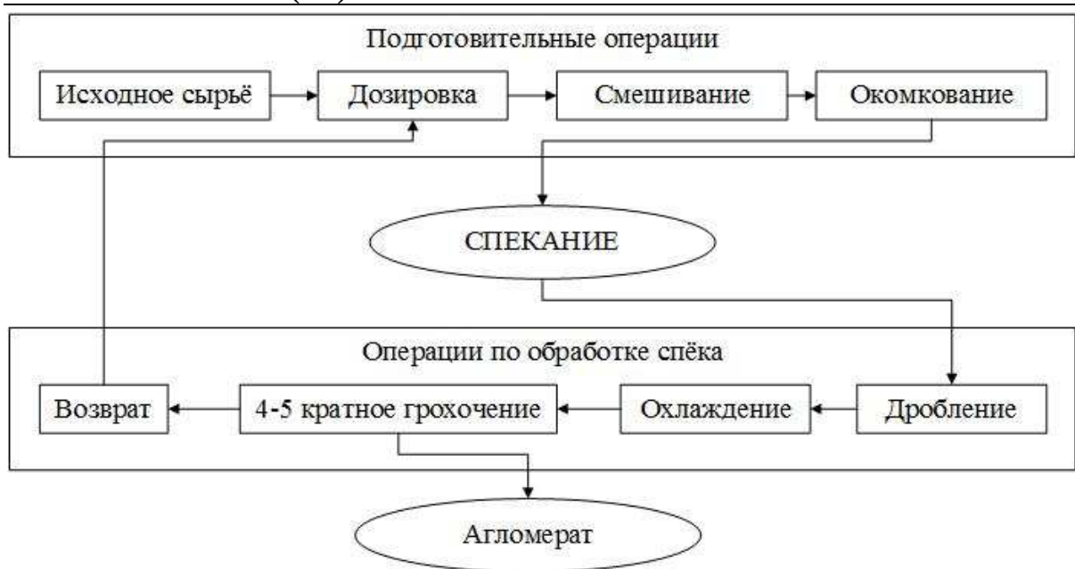
Рисунок 1 - Существующая модель производства агломерата
