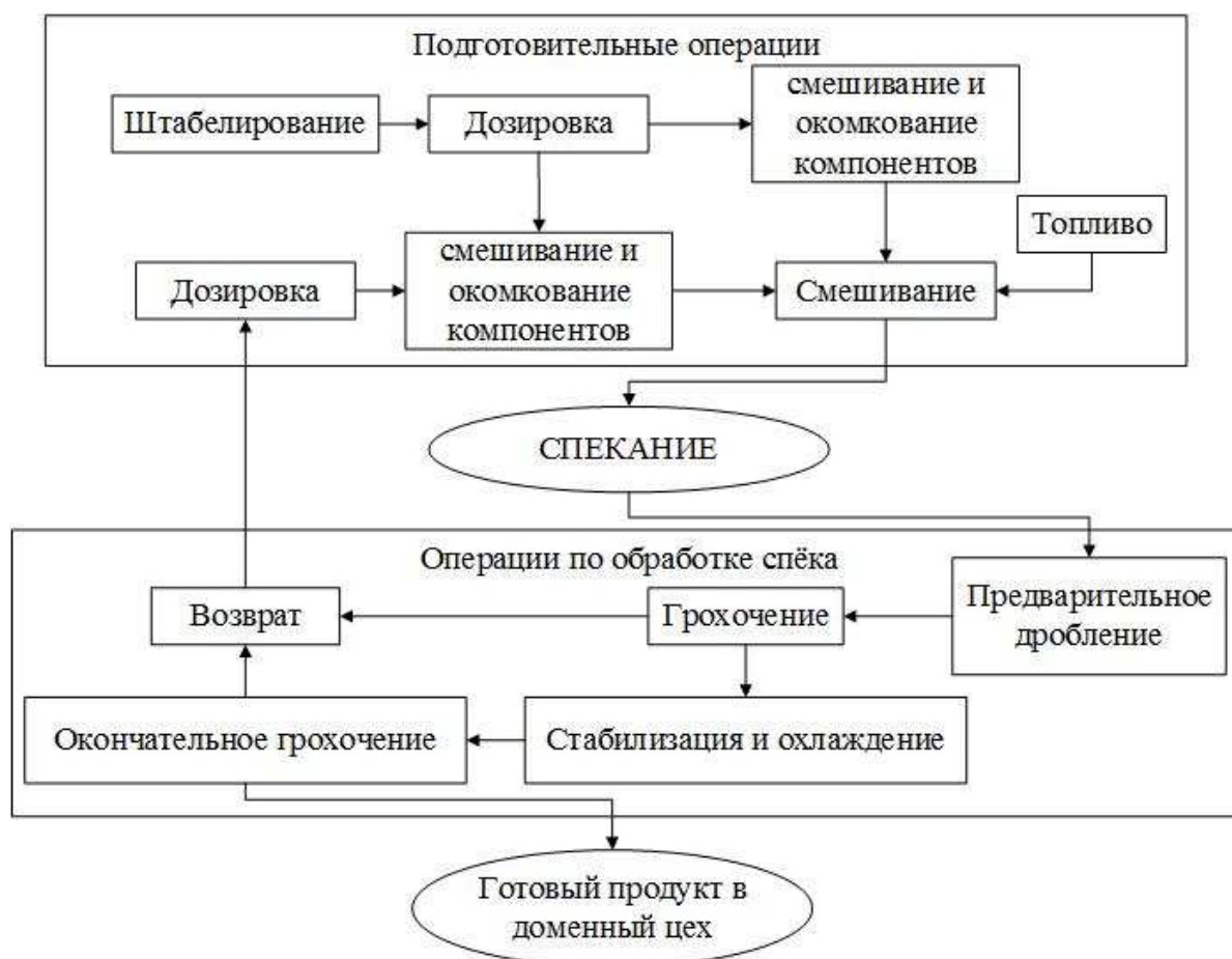
Рисунок 2 - Схема получения стабилизированного агломерата
