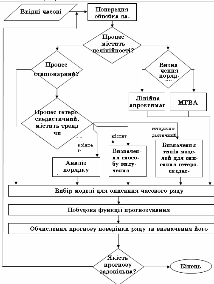
Рисунок 1 - Схема процесу динамічного прогнозування на основі часових рядів
