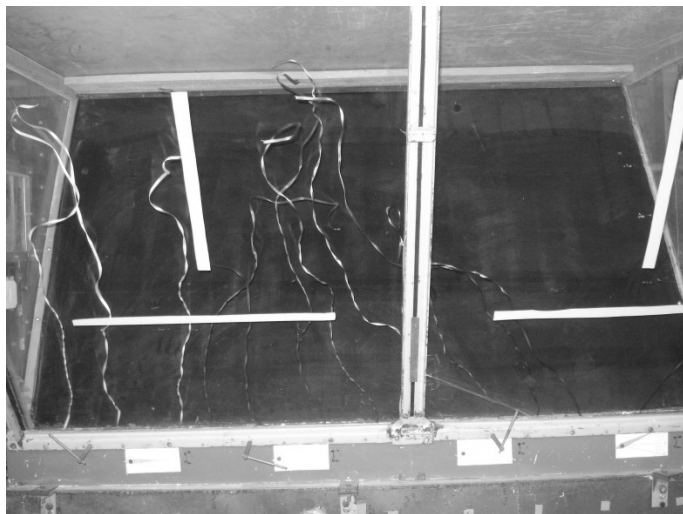
Рисунок 2 - Визуализация воздушного потока с помощью разноцветных лент при среднем режиме подачи воздуха с наклоном лопаток 0^\circ , 0^\circ , 0^\circ , +15^\circ
