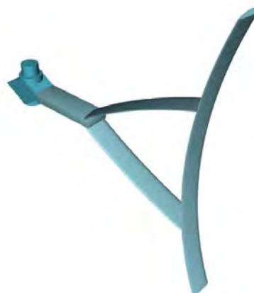
Рисунок 2 – Схема узла лопасть-траверсы
