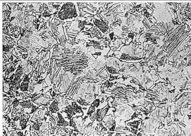
Рисунок 1 - Мікроструктура (х400) сталі 09Г2 прямокутної труби в гарячекатаному стані поставки
