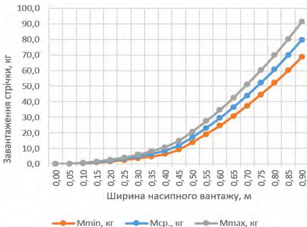
Рисунок 2 - Залежність завантаження стрічки конвеєра від ширини насипного вантажу для \varphi_{рух.мин} = 13,5^\circ , \varphi_{рух.сер.} = 18,0^\circ , \varphi_{рух.мак} = 22,5^\circ
