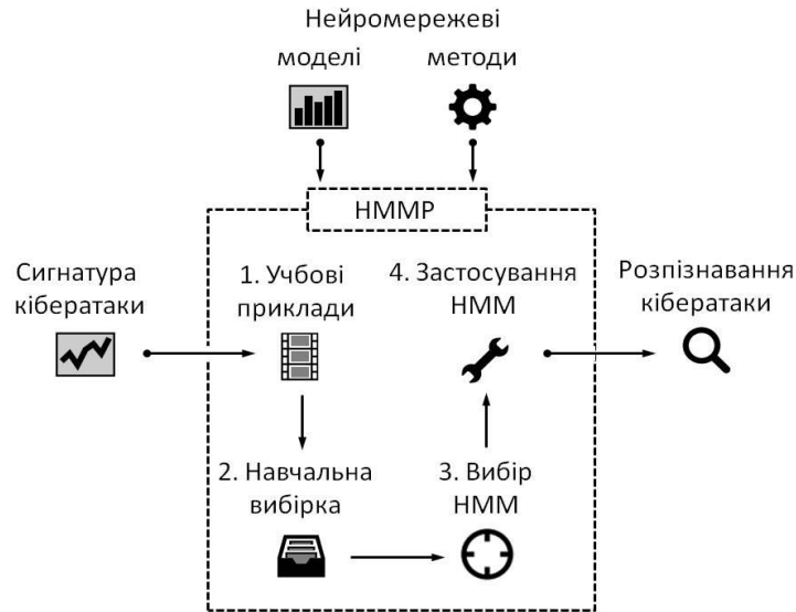
Рисунок 1 - Діаграма процесу нейромережевого розпізнавання кібератак на мережеві ресурси
