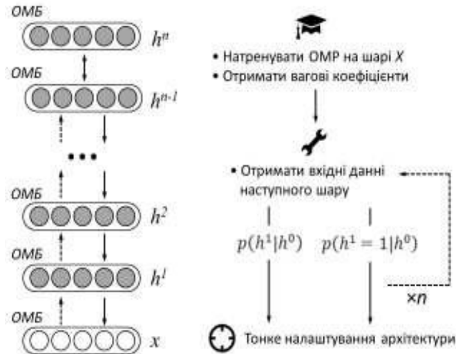
Рисунок 4 - Структура та алгоритм тренування ГМП
