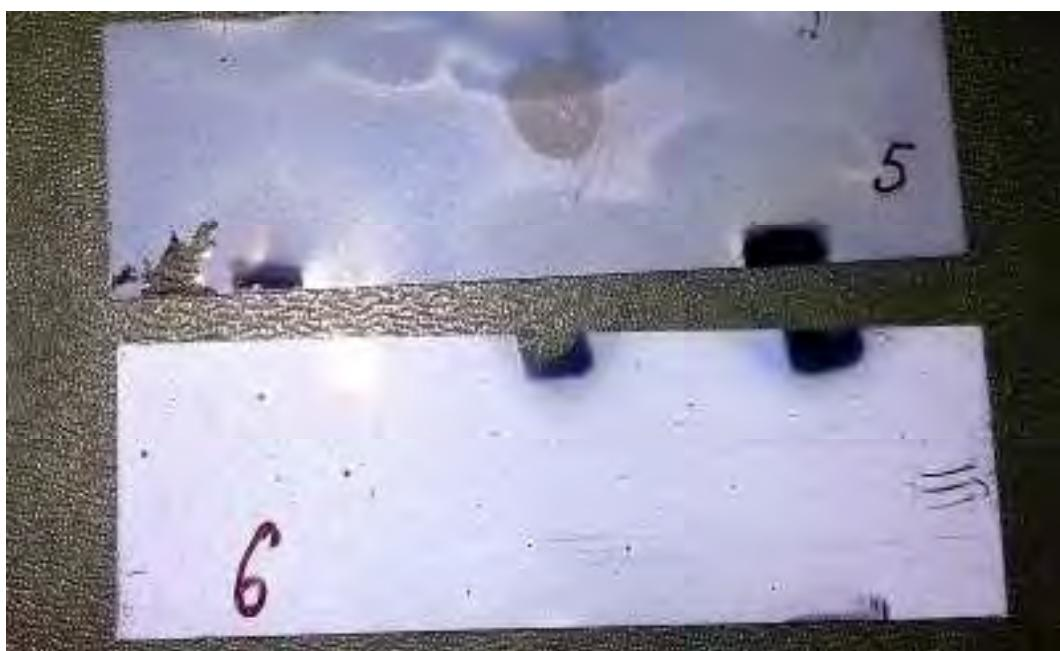
Рисунок 1 – Фотографии пленок нанесенных при разном давлении
