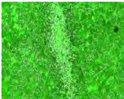
Рисунок 1 – Зразок № 12 (плавка № 22325), полоса мартенсіта
