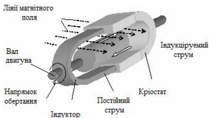
Рисунок 1 – Індукційний нагрів заготовки в магнітному полі
