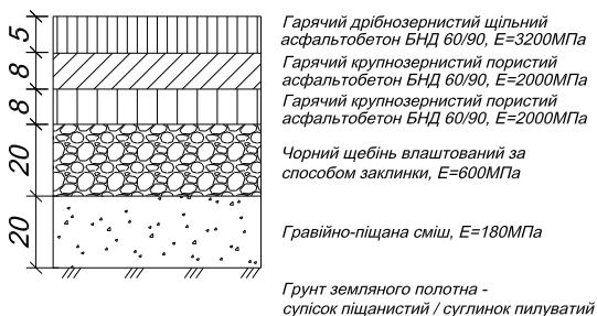
Рис. 1. Капітальний тип конструкції дорожнього одягу
