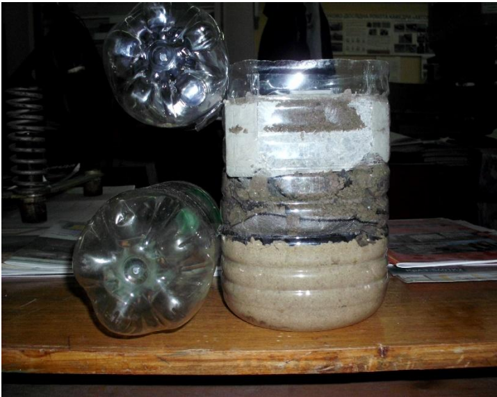
Рис. 4. Модель тротуарного покриття з профільованою мембраною
