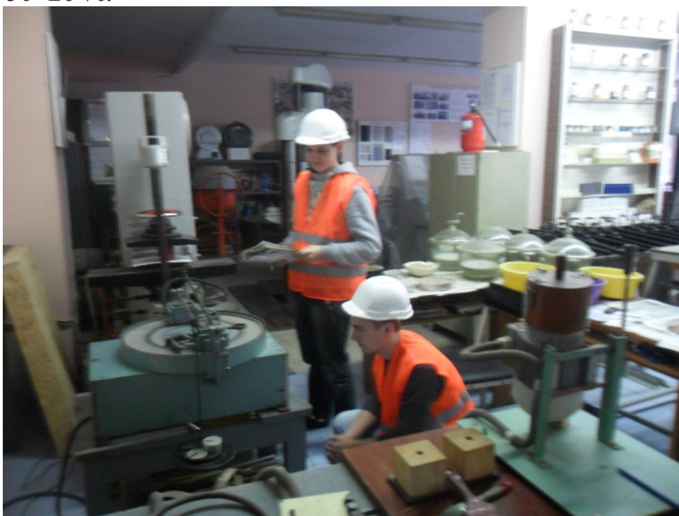
Рис. 1. Визначення стираності на приладі ЛКИ-3.
