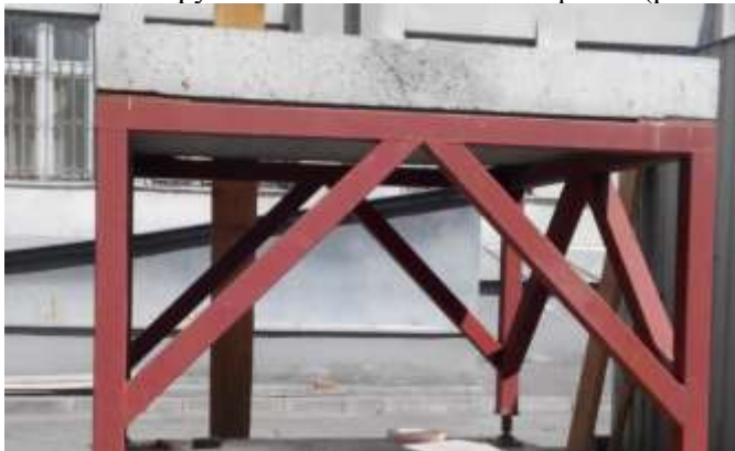
Рис. 6. Модель строительной конструкции системы «Монофант»
