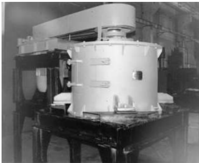
Рис.1. Дробилка ударного действия для получения кубовидного щебня
