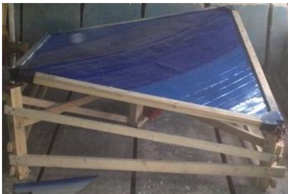
Рис. 3. Вид оболочки из параболических панелей размером 3000х3000х35мм в лаборатории кафедры МДиПК ОГАСА
