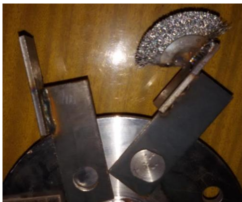
Рис. 7. Варианты исполнения ударных элементов.
