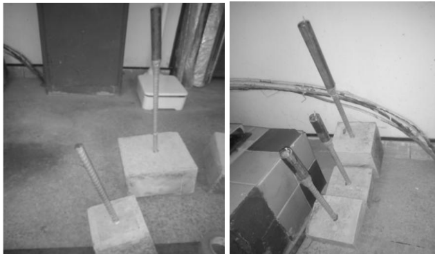
Рис. 2. Захист арматурного стержня від пошкодження в захваті преса
