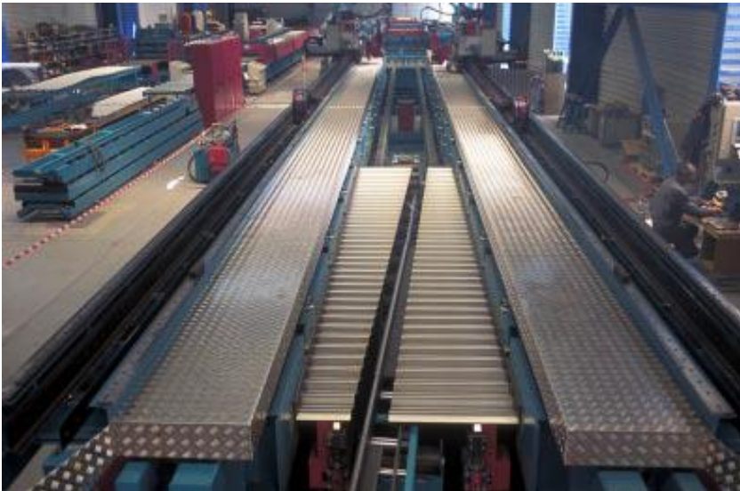
Рис. 2. Виготовлення двотаврів змінного перерізу із гофрованою стінкою
