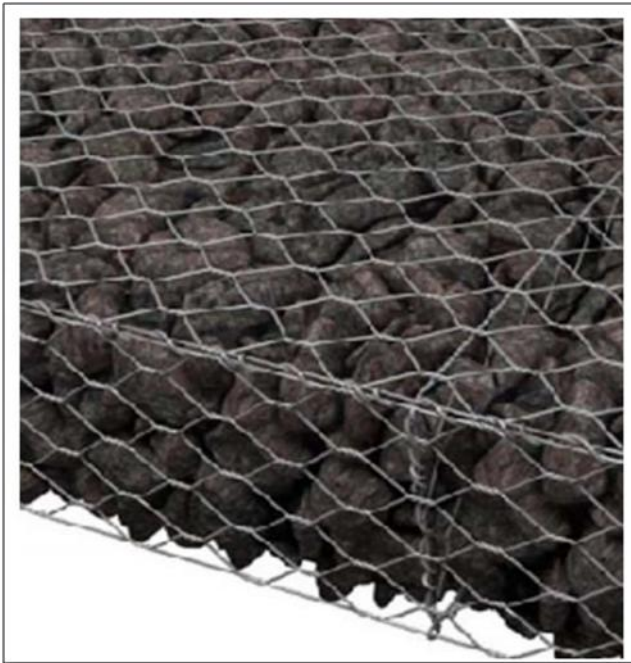
Рис.1 Схема габіонного матрацу типу «Рено»
