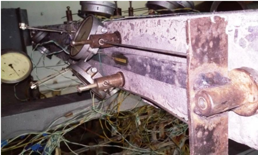
Рис. 2. Індикатори та датчики для виміру сумісного деформування стрічки та бетону балки
