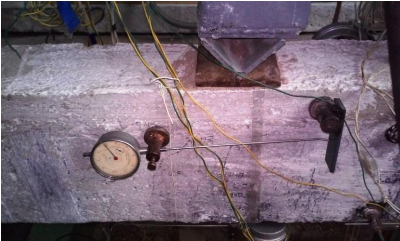
Рис. 3. Індикатори для виміру сумісного деформування бетону підсилення та бетону балки
