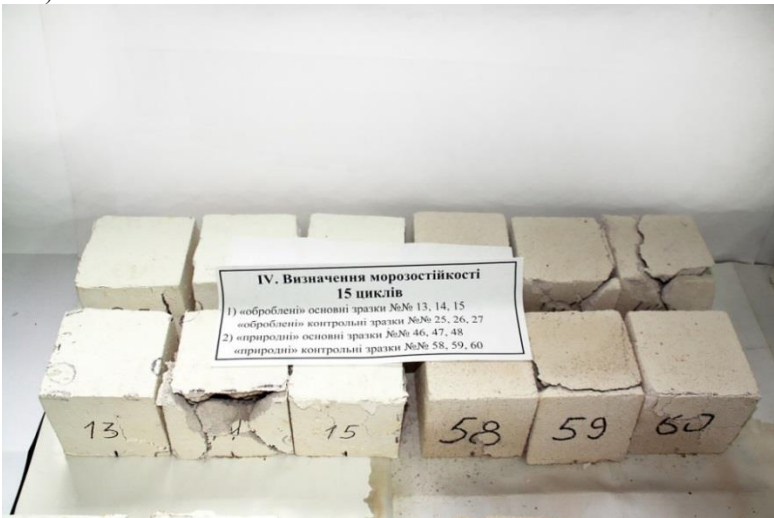
Рис. 2. Зразки після 15-го циклу випробування на міцність
