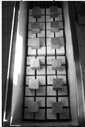
Рис. 1. Зразки газобетону в необробленому стані (на фото - знизу), та в обробленому стані (на фото - зверху)
