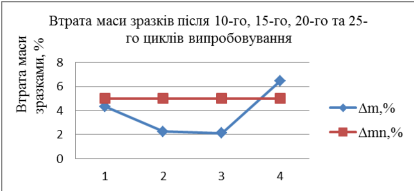
Рис. 3. Втрата маси зразків після 10-го (1), 15-го(2), 20-го (3) та 25-го (4) циклів випробування необроблених зразків
