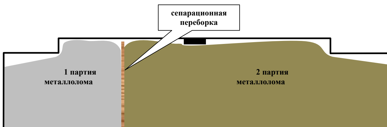
Рис. 8. Установка сепарационной переборки
