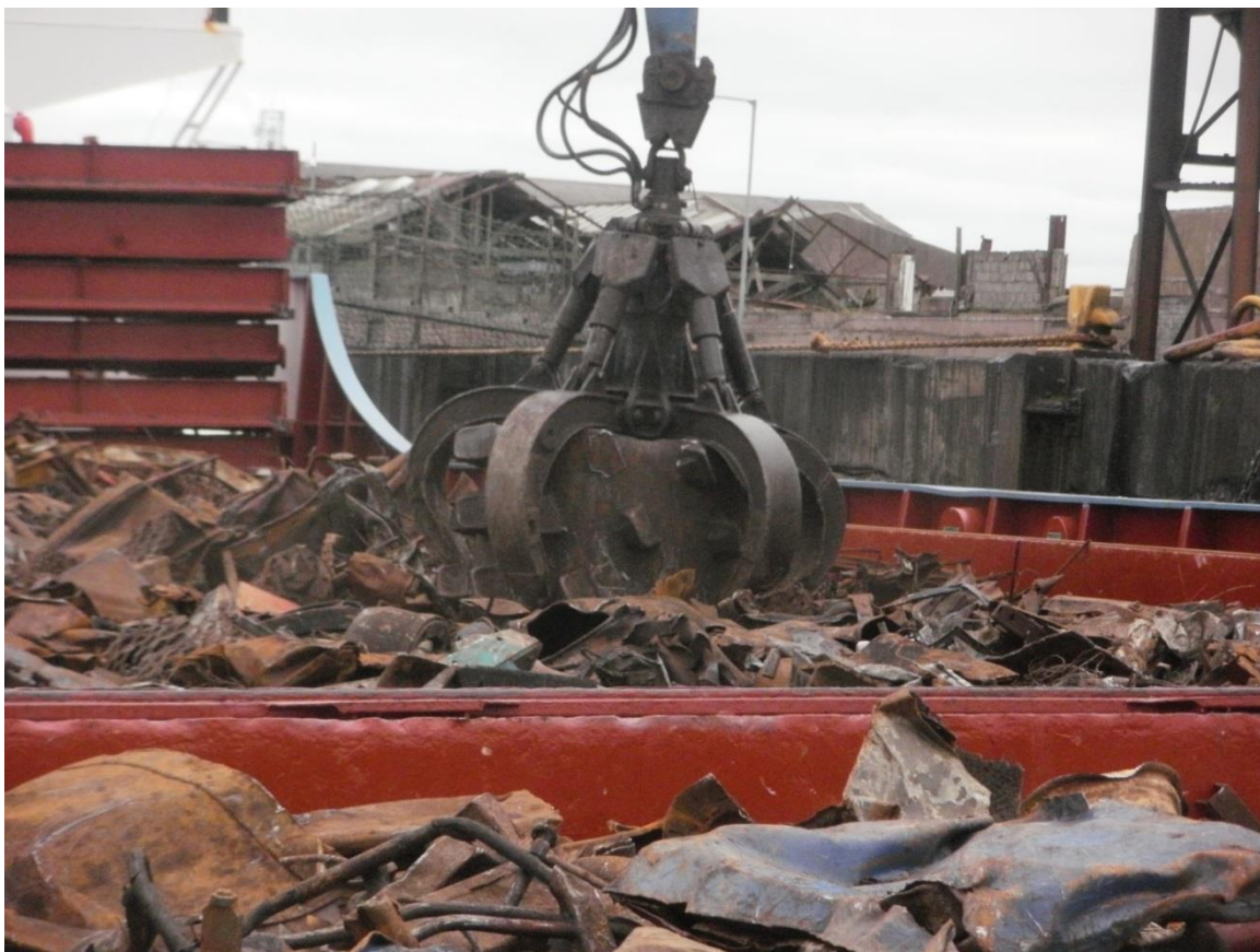
Рис. 7. Прессование груза металлолома в трюме т/х «PLATO»
