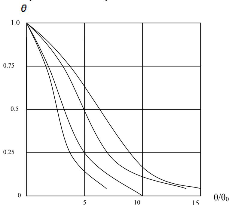
Рис.1. Относительное изменение ширины диаграммы направленности антенны судовой РЛС в зависимости от величины  $\frac{\theta}{\theta_0}$  и коэффициента  $a$ .
