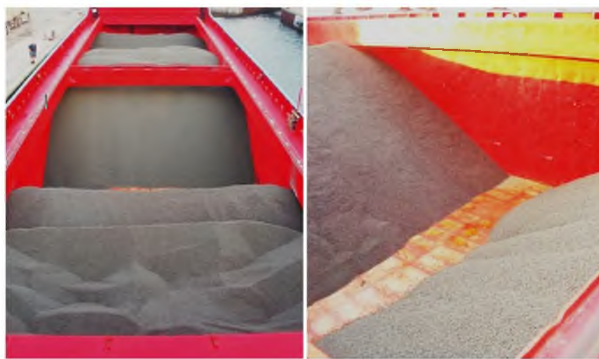
Рис. 5 Загрузка трёх различных штабелей груза щебня методом «естественной» сепарации на т/х «Wilson Bilbao»
